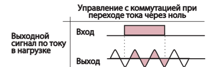
1.1. Диаграмма срабатывания ТТР KIPPRIBOR с контролем перехода через ноль
