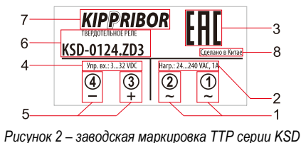
Рисунок 2 – заводская маркировка ТТР серии KSD
