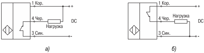
Рисунок 23 - Схема подключения трехпроводных NC – датчиков а) NPN типа, б) PNP типа
