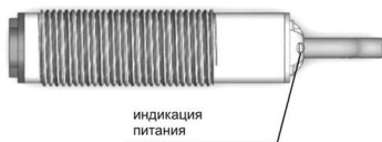
Рисунок 30 – LED – индикатор питания на излучателе OA18-T1
